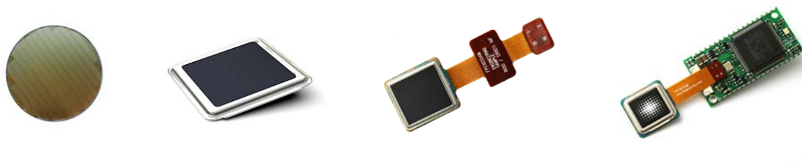
图 28. 晶片、LGA、模块和独立的嵌入式系统
